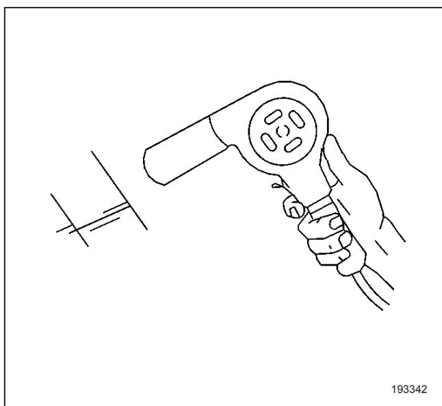
19. 按照制造商的说明固化维修材料。
