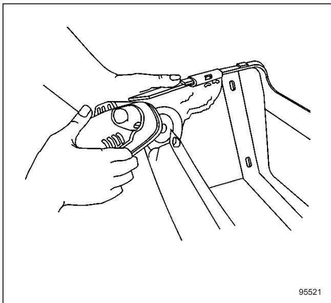
4. 在 DA 砂光机上用 80 目砂轮打磨内表面，如果空间有限则手工打磨。
