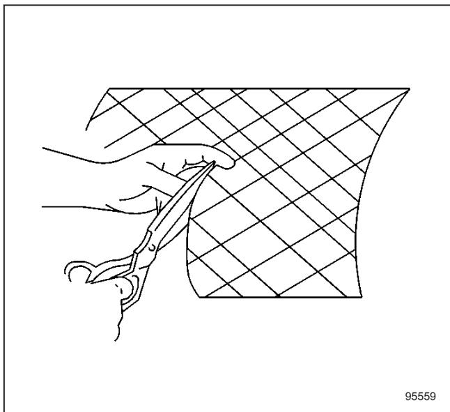
2. 按所需形状裁剪一块玻璃衬垫，衬垫应延伸到维修部位以外 38-51 毫米（1.5-2.0 英寸）。
