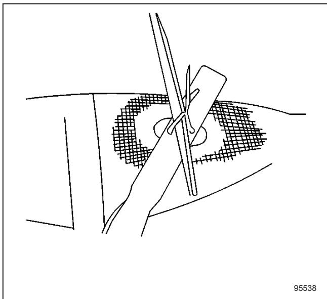
20. 将蜡线绕紧在一个木块上，使衬条固定到位，直到维修材料固化。
