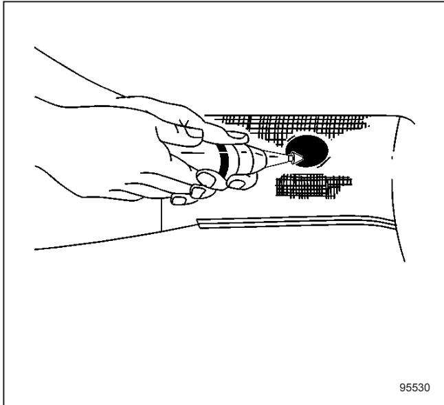
4. 研磨或锉削损坏部位边缘，以形成一个盘形。
