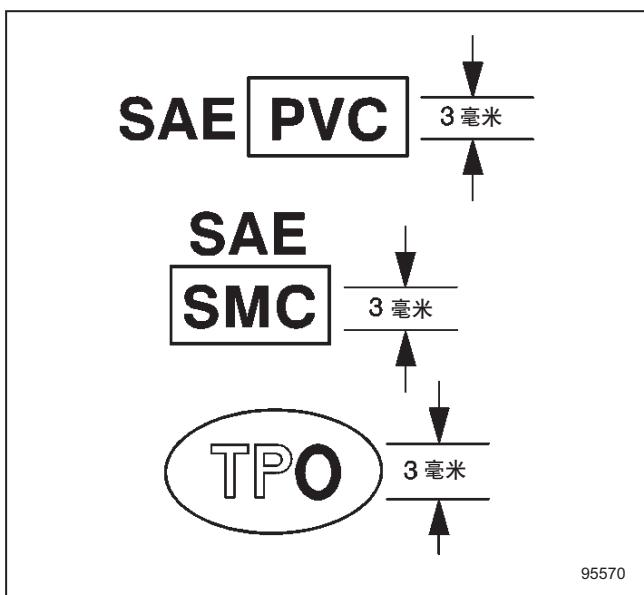
塑料件可通过美国汽车工程师协会 (SAE) 代码（通常位于零件后面）和 / 或塑料的特性进行识别。了解塑料的类型有助于选择正确的维修材料和维修程序。
